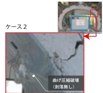
タフネスコート (1.5mm) で被覆したコンクリート覆工 (鉛直変位  $\delta=70\text{mm}$ 時)
